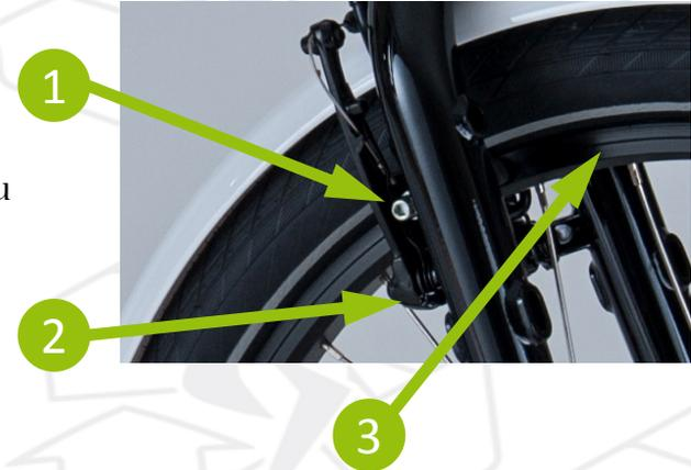
Afin d'ajuster les étriers de freins, il est nécessaire d'équilibrer la tension des ressorts de rappel grâce aux vis d'équilibrage (2). Veillez à avoir le même écartement des étriers de part et d'autre de la jante.
